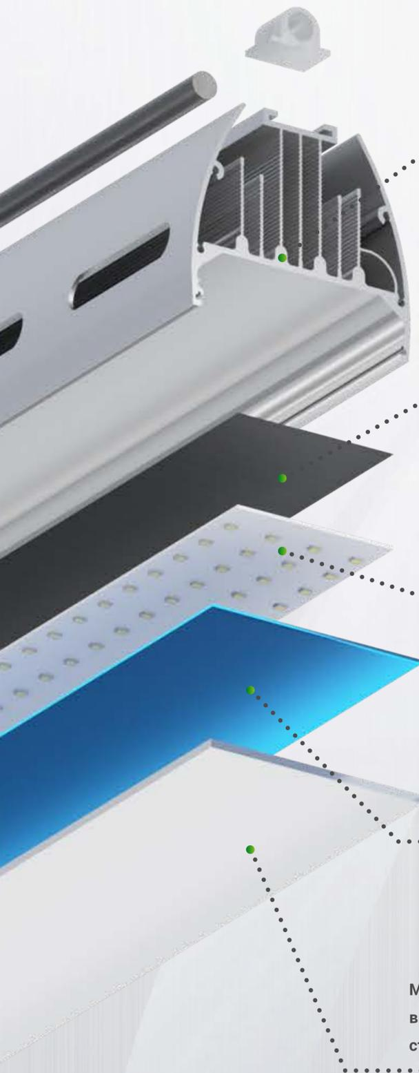
Корпус светильника изготавливается из анодированного алюминия методом экструзии. Благодаря уникальной форме эффективно рассеивает тепло позволяя увеличить срок службы светильника до 200000 часов
